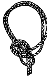
Рис. 364. Двойной беседочный узел (двойной булинь)
