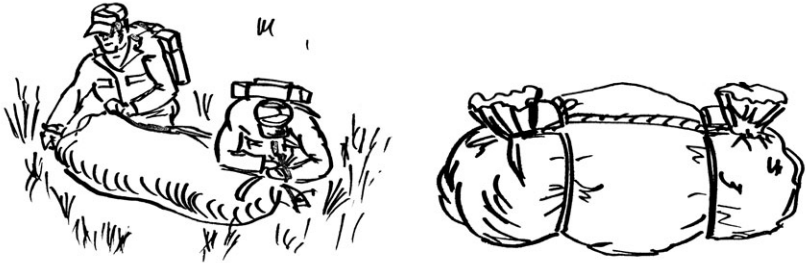
Рис. 53. Плащ-палатка, набитая сеном или соломой для использования ее в качестве опоры в плотях
