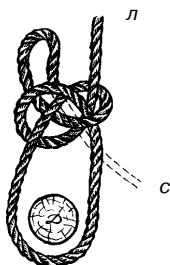
Рис. 372. Калмыцкий узел. Пунктиром показано продевание свободного конца обратно для образования петли
