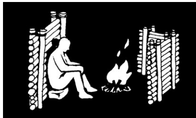
Рис. 232. Костер с отражателем. Вертикальная стенка из сырых бревен
