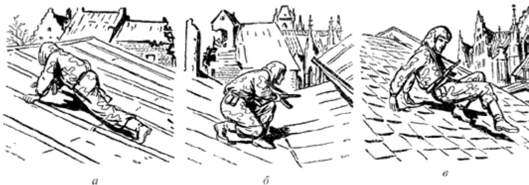
Рис.42. Лазание по крышам: а – лицом к крыше на четвереньках; б – сидя; в – на четвереньках спиной к крыше
