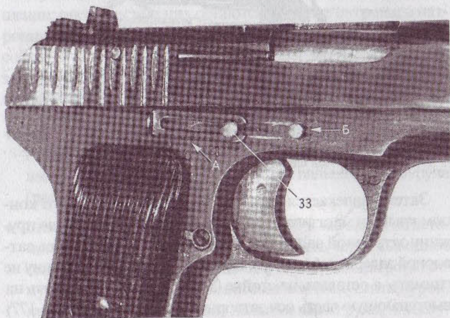
Рис. 177. Разборка пистолета: А — сдвинуть назад пружину затворной задержки и оставить ее на стойке; Б — нажать на ось затворной задержки и утопить ее
