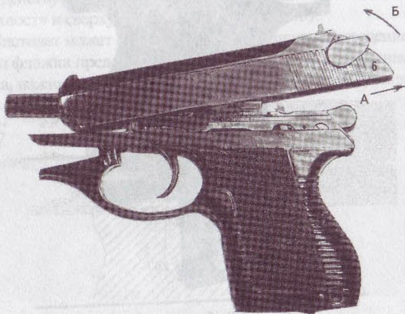
Рис. 354. Разборка пистолета. Затвор (6): А — отвести назад; Б — поднять и снять движением вперед
