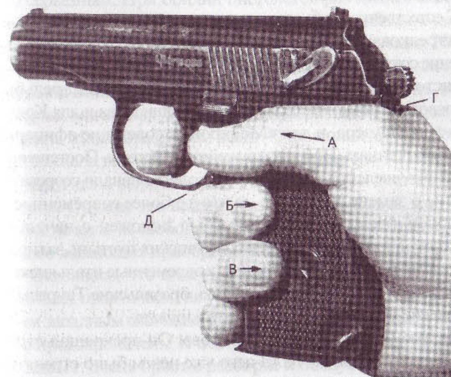
Рис. 335. Правильная «хватка» боевого пистолета при стрельбе: А — большой палец плотно прижимается к плоскости оружия; Б–В — подушечки среднего и безымянного пальцев плотно «вжимают» рукоятку пистолета в ладонь; Г–Д — в этих местах пистолет плотно «посажен» в кисть руки
