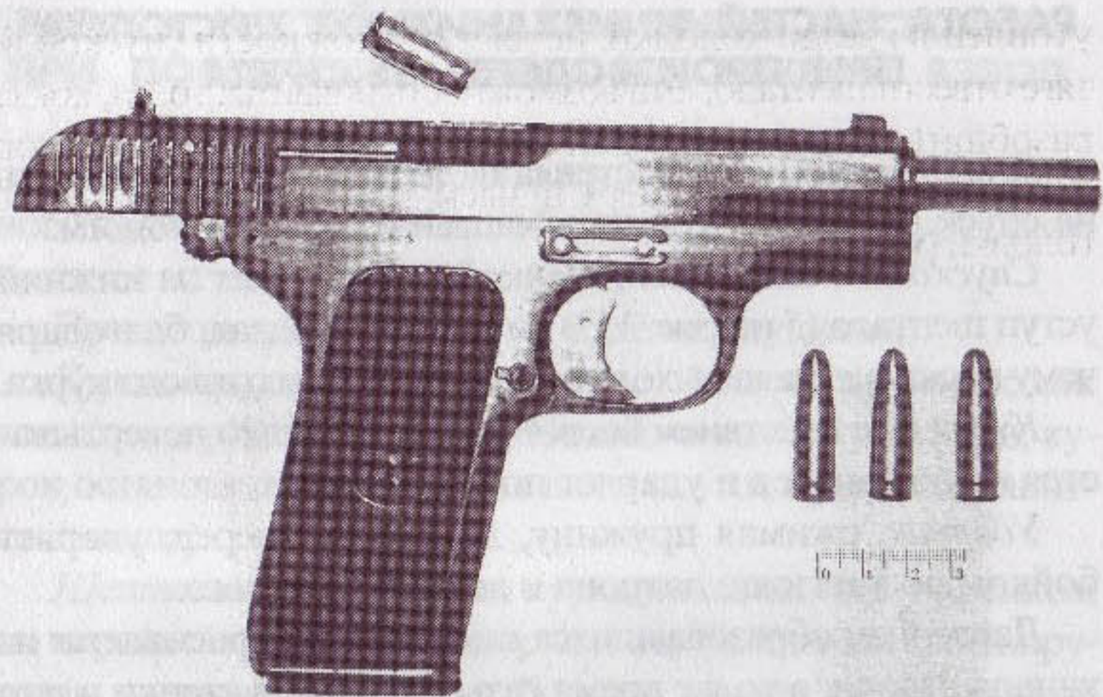
Рис. 171. Отход затвора назад после выстрела
