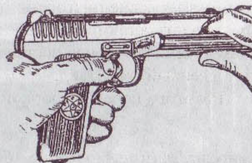
Рис. 175. Как сдвинуть пружину затворной задержки
