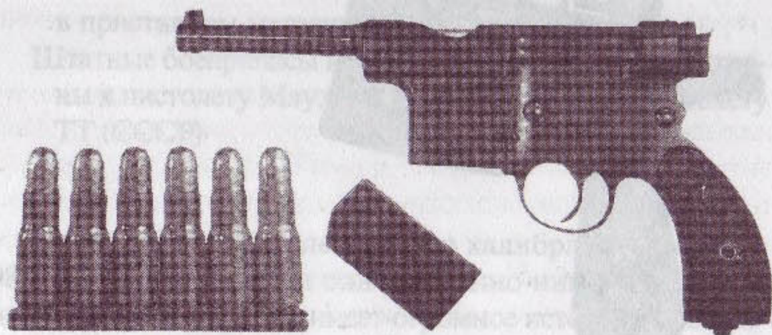
Рис. 100. Прототип Маузера — испанский пистолет Чарола Анитуа калибра 7 мм и обойма из шести патронов к нему
