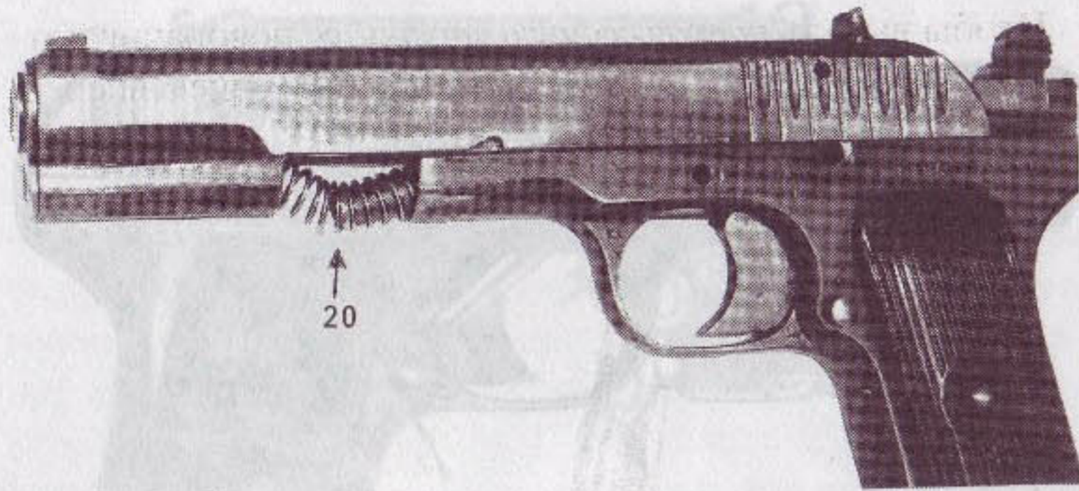
Рис. 180. Разборка пистолета: после извлечения затворной задержки отделить вперед затвор со стволом. Возвратную пружину (20) придерживать от самопроизвольного «выворачивания» наружу
