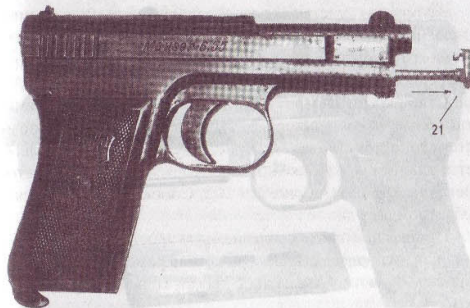
Рис. 220. Разборка пистолета: извлечь направляющий стержень (21) движением «к стволу»
