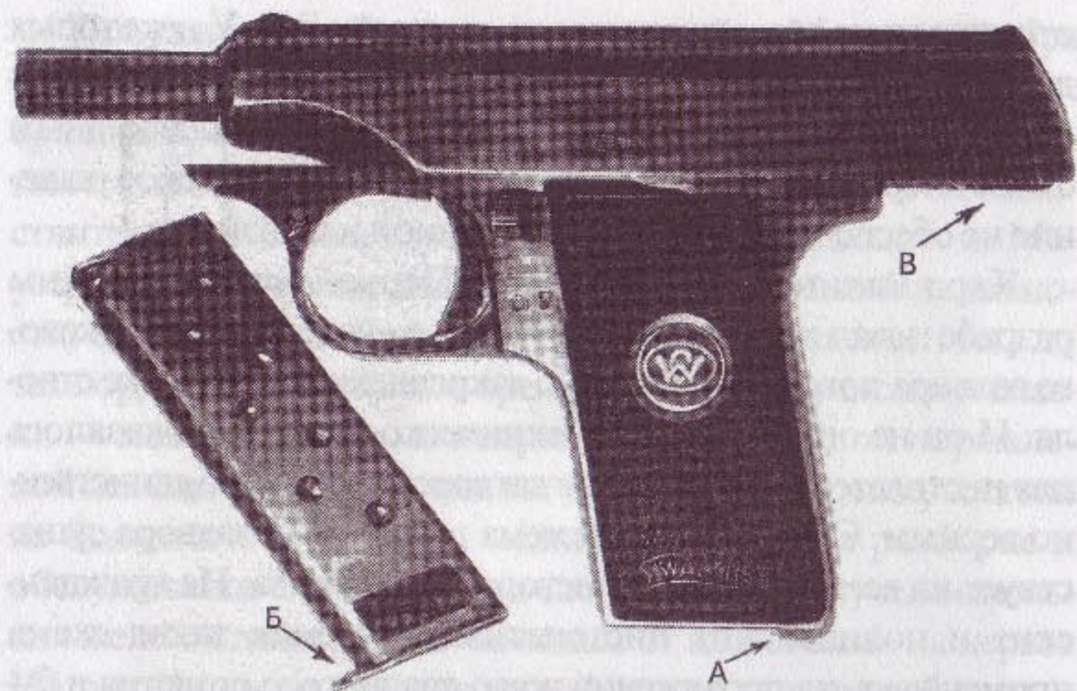
Рис. 231. Проверка на незаряженность в последовательности действий: А — отжать защелку магазина; Б — извлечь магазин; В — отвести назад затвор
