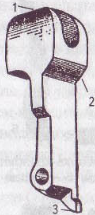
Рис. 32. Казенник: 1 — головка; 2 — скошенная часть головки; 3 — выступ
