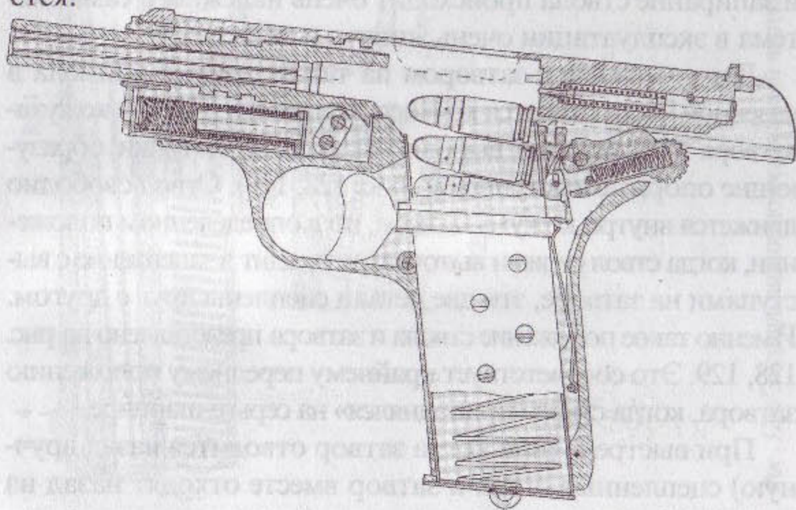
Рис. 130. Положение подвижных деталей после выстрела: ствол опустился на серьге-шарнире и расцепился с кожухом затвора
