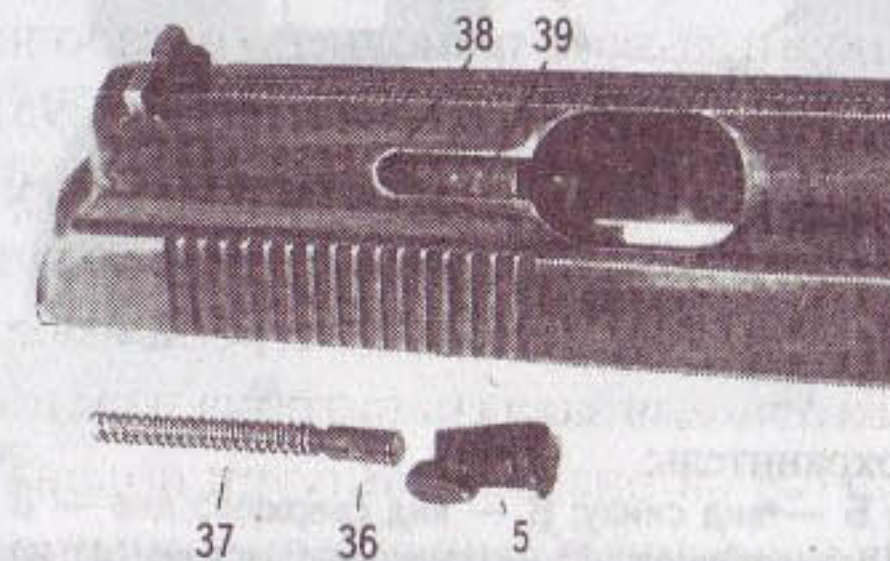
Рис. 297. Выбрасыватель и его посадочное место: 5 — зацеп-выбрасыватель; 36 — гнеток; 37 — пружина выбрасывателя; 38 — сверление для гнетка и пружины выбрасывателя; 39 — посадочное место выбрасывателя
