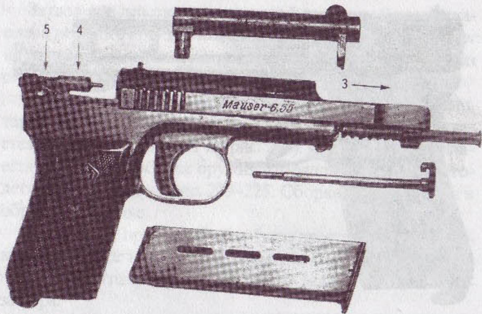
Рис. 222. Затвор (3) податъ вперед и отделить вместе с возвратной пружиной; 4 — ударник во взаимодействии со сжатой боевой пружиной (5)
