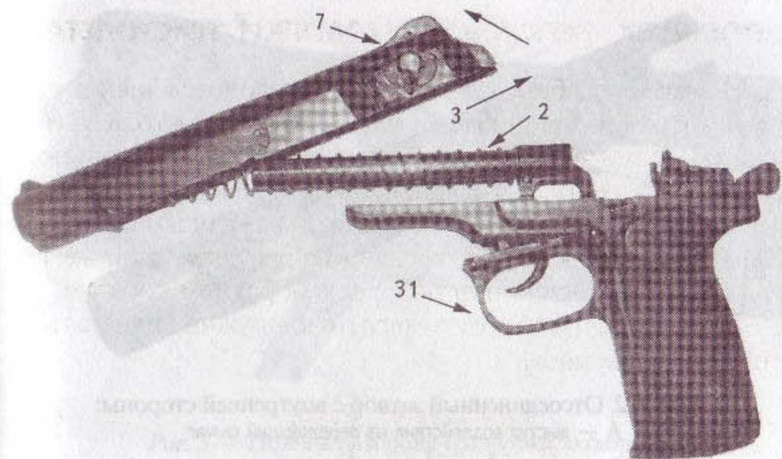
Рис. 370. Неполная разборка: снять пистолет с предохранителя (7); опустить вниз спусковую скобу (31); затвор (3) отвести назад, поднять вверх и отделить; снять со ствола возвратную пружину (2)
