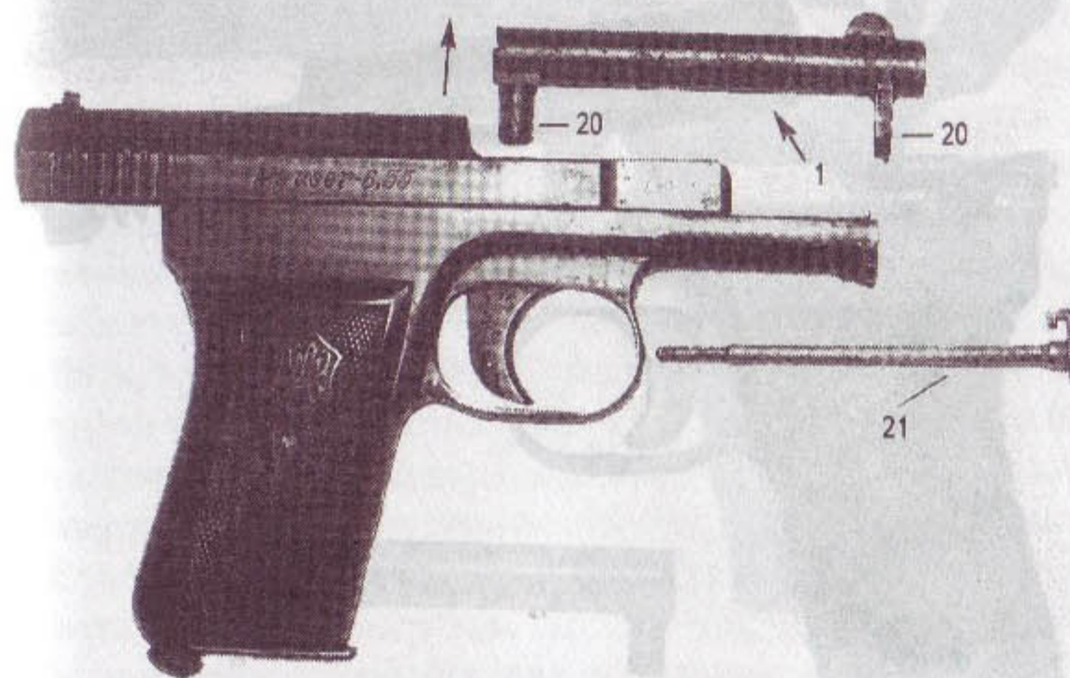
Рис. 221. Разборка пистолета: ствол (1) отделить от рамки движением вверх
