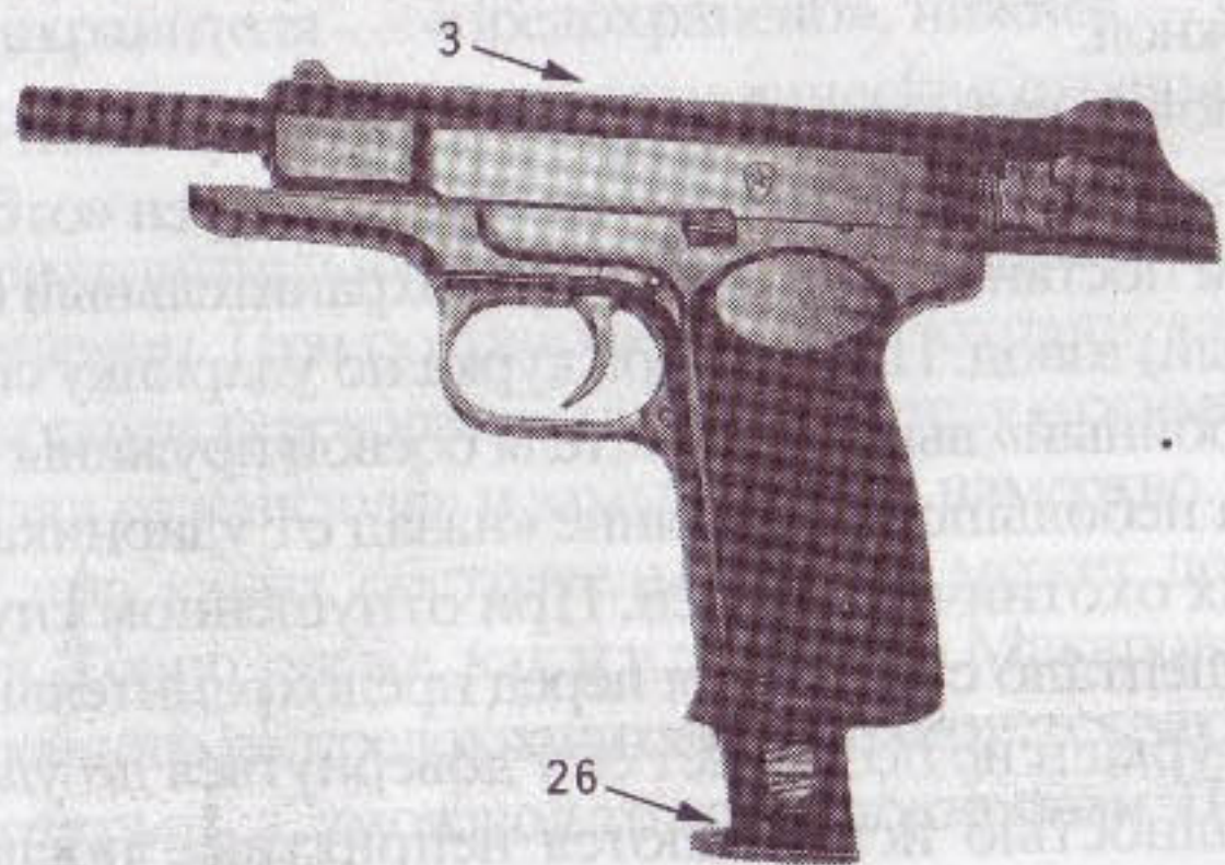
Рис. 369. Неполная разборка: при извлеченном магазине (26) отвести назад затвор (3). Проверить оружие на незаряженность
