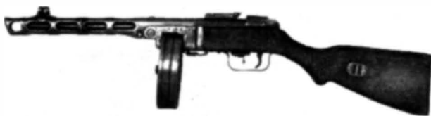
7,62-мм пистолет-пулемет ППШ-41
