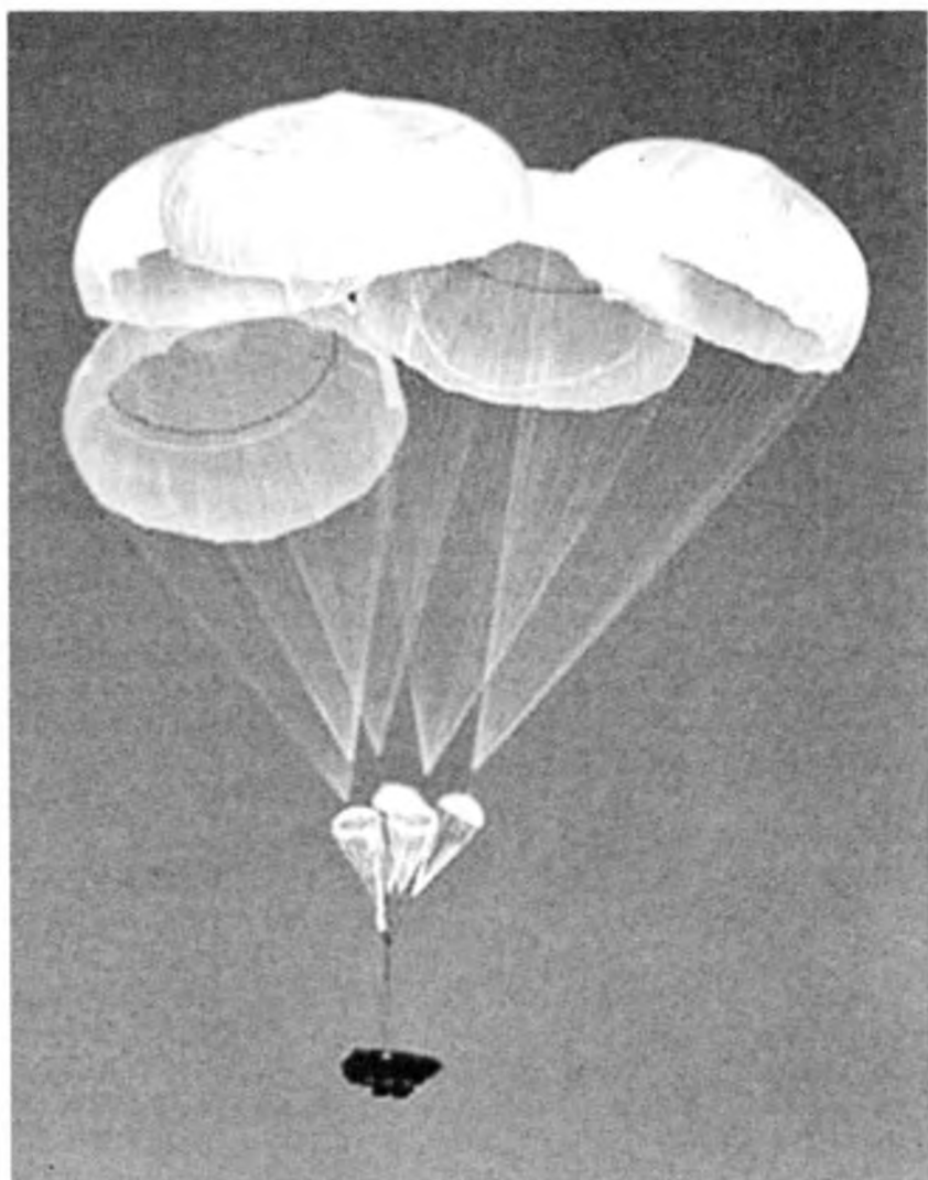
Многокупольная парашютная система МКС-5-128М
