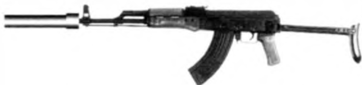
7,62-мм автомат АКМС-Л с прибором бесшумной стрельбы ПБС-1
