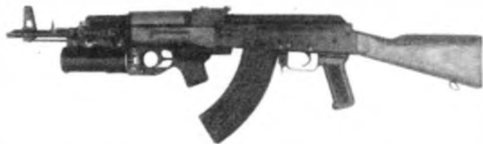
40-мм подствольный гранатомет ГП-25 на автомате АКМ
