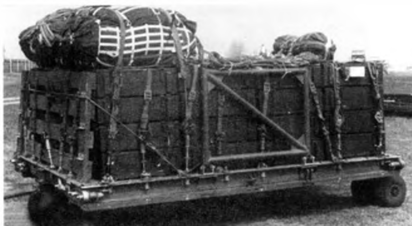
Парашютная платформа ПП-128-5000 с ящиками с боеприпасами
