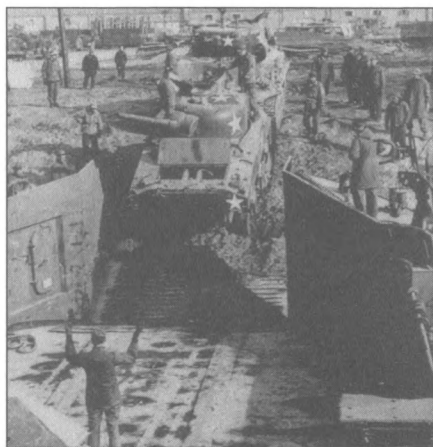
Американский танк «Шерман» М-4 толкает другой танк «Шерман» на танкодесантное судно в Инчхоне для эвакуации в Японию и ремонта. 1-м танковым батальоном морской пехоты танки «Шерман» использовались как огнемётные танки и как бульдозеры, М-26 еще не был приспособлен к таким возможностям. (US Navy)
